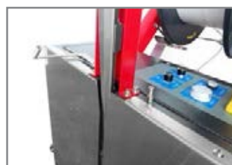
TESTA DI REGGIATURA LATERALE SIDE STRAPPING HEAD
