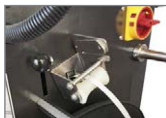
CARICAMENTO AUTOMATICO DELLA REGGIA AUTOMATIC STRAP LOADING
