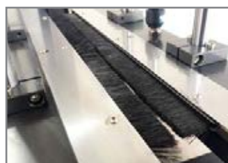
DETTAGLIO PRESSINO PNEUMATICO PNEUMATIC TOP PRESS
