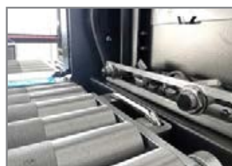
FOTOCELLE PER LETTURA PACCO PHOTOCELLS TO DETECT THE PRODUCTS
