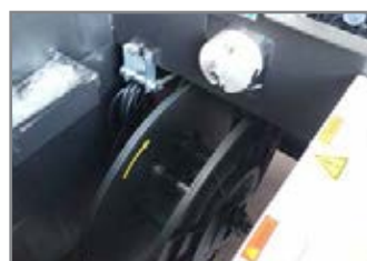
ALLOGGIO INTERNO BOBINA REGGIA INTERNAL STRAP COIL HOLDER
