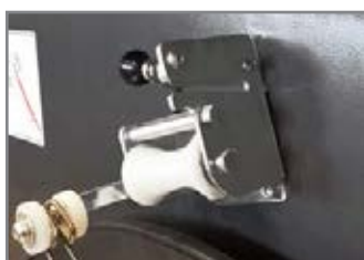
INSERIMENTO E TAGLIERINA PER REGGIA AUTOMATIC STRAP FEEDING AND CUTTER
