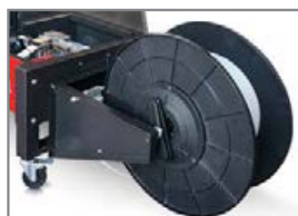
SISTEMA DI SUPPORTO BOBINA REGGIA STRAP COIL SUPPORT SYSTEM
