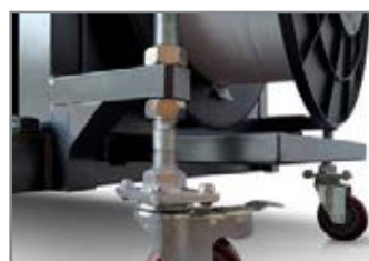
REGOLAZIONE ALTEZZA PIANO DI LAVORO ADJUSTABLE WORKING TABLE HEIGHT
