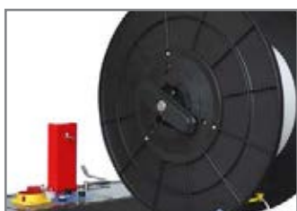
SISTEMA RAPIDO SOSTITUZIONE REGGIA EASY STRAP COIL CHANGE
