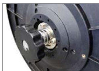
AGGANCIO/SGANCIO RAPIDO BOBINA REGGIA FAST STRAP COIL CHANGE
