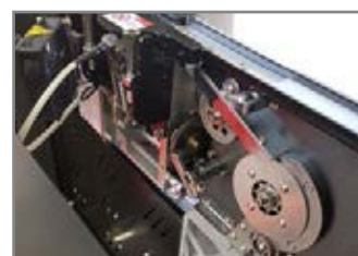
GRUPPO DI REGGIATURA CON MOTORI IN C.C. DC MOTORS STRAPPING GROUP
