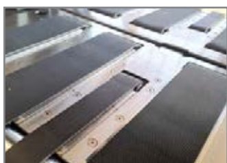
PIANO CON TAPPETI MOTORIZZATI MOTORIZED BELTS CONVEYOR
