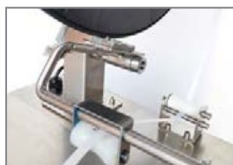
PASSAGGIO ESTERNO REGGIA EXTERNAL STRAP POSITION
