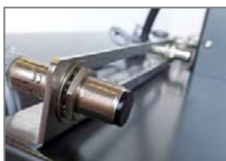
FOTOCELLULA LETTURA PRODOTTO PHOTOCELL TO DETECT PRODUCTS
