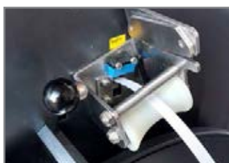
INSERIMENTO E TAGLIERINA PER REGGIA AUTOMATIC STRAP FEEDING AND STRAP CUTTER
